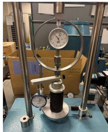
図-4 添加率5%の供試体の一軸圧縮試験状況
