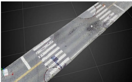
図-5 建設業に導入されているICT機器（3次元点群データ）
