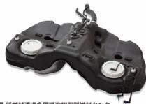
4層6層 低燃料透過多層構造樹脂製燃料タンク
