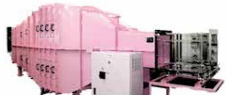
風洞(流路断面:500mm×500mm, 最大風速33m/s)
