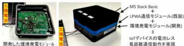
屋外における低消費電力IoT用途に適した環境発電モジュールの開発
