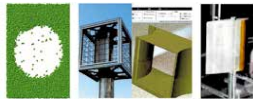
ファインバブルの分子動力学シミュレーション(左), 風レンズ付き垂直軸型風車と数値流体シミュレーション(中央2つ), プラズマアクチュエータ付き翼型(右)
