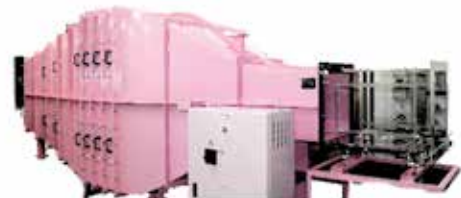
風洞(流路断面:500mm×500mm, 最大風速33m/s)
