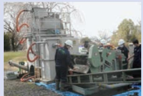
浚渫底泥を凝集分離・脱水土として回収
