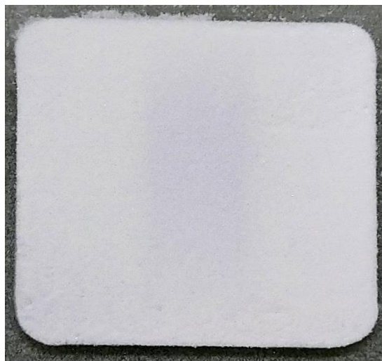
図-6 X線回折測定後の試料D (KCl) の様子
