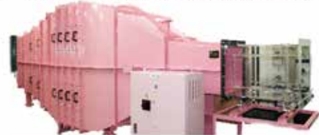
風洞(流路断面:500 mm×500 mm, 最大風速30 m/s)
