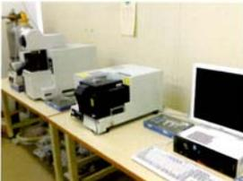
**2 ゼータ電位・粒径測定システム**
