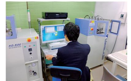
樹脂材料を昇温させながら変位を測定する装置です。規定の変位に至る際の温度を測定し、樹脂の耐えうる最高温度が求められます。油浴槽と大気槽でそれぞれ実験でき、荷重条件や昇温速度を変えて実験します。大気槽は密閉式になっており、架台は熱老化や温度ひずみを解消するため、石英ガラスでできています。
