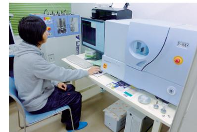
コンパクトで使いやすく高性能な卓上型X線CT装置です。生体、医薬品・骨・非鉄・樹脂成形品・小型電子部品の非破壊検査や解析に適しており、オフセットコーンビームCTで一度に複数枚の高画質断面像が得られます。撮影するサンプルの透視画像も自動保存します。
