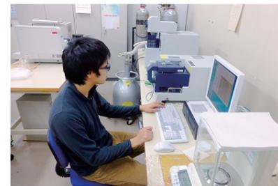
固体試料を加熱した際に生じる重量減少、発熱や吸熱の変化などを測定し、材料の耐熱性、融点、ガラス転移点などの物質の熱挙動を求める装置です。耐熱性材料や高温材料の開発に威力を発揮します。
