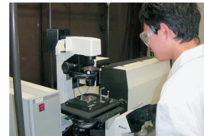
三次元顕微レーザーラマン分光装置はサブミクロン～ナノメートル領域の物質の化学状態を3次元計測できる分析装置です。サンプルの前処理不要、非破壊で大気中測定。ナノハイオ、半導体、カーボンナノチューブ、液晶、高分子、光導波路、ガラス、フォトニクス結晶、ナノ粒子等ナノテクノロジー分野の計測に貢献しています。
