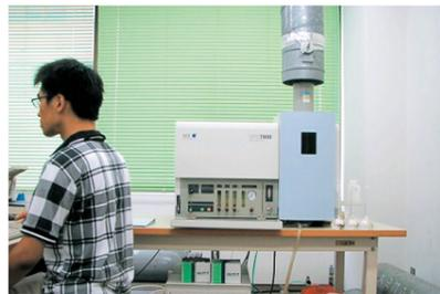
工場排水、環境水、廃棄物からの溶出水などに含まれる微量金属を測定します。測定温度は、ppmからppb程度まで。主成分から微量成分まで多元素一斉分析が可能で、水環境保全に大きく貢献します。
