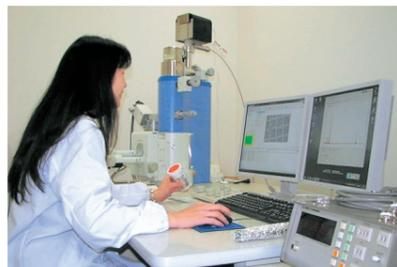
金属、プラスチック、セラミックス、生物体など固体表面を観察します。最高倍率30万倍。低真空中観察可能です。試料の調整が容易で、製品の品質管理、新材料の開発、不良品対策、性能向上などに効果抜群です。
