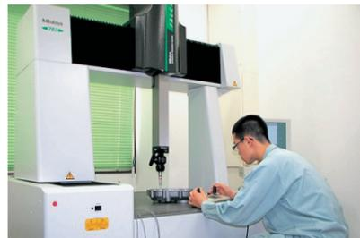
機械加工した精密部品の三次元的な形状や寸法を精密に測定する機器。測定可能範囲705×705×605mm、測定精度4μm程度。形状評価を精密に行うことで、技術力の向上、新製品開発に貢献します。
