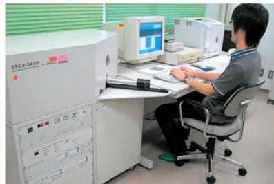
物質にX線を照射すると固体表面から光電子が放出します。この光電子のエネルギーを測定することで、固体表面層の元素分析、酸化の状態、化学構造などを測定します。材料の新機能の発生機構の解明に威力を発揮します。新材料開発、不良品対策には不可欠な機器です。
