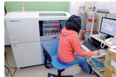
固体、粉体、液体試料に含まれている各種の元素の定性分析や、定量分析がエネルギー分散型蛍光X線分析法を活用してできます。試料中に含まれるNa～Uまでの多元素を同時に分析します。
