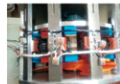
通常のモーター（コイル縦配置） ・回転中心側の片極に発生する磁力は、回転動作に貢献しない。
